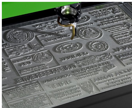
Gravieren & Schneiden von individuellen Farbstempeln
